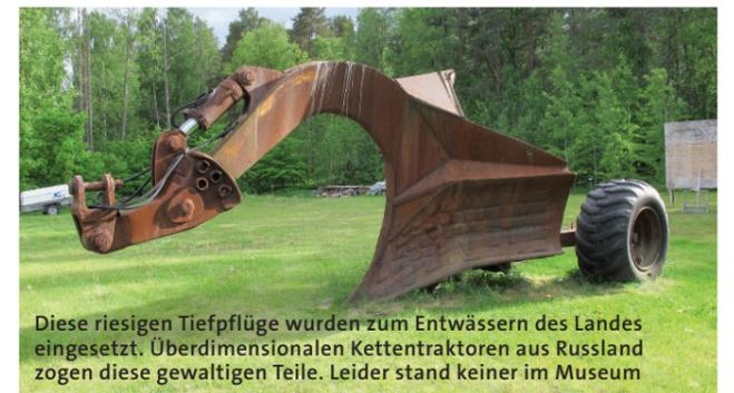
Diese riesigen Tiefpflüge wurden zum Entwässern des Landes eingesetzt. Überdimensionalen Kettentraktoren aus Russland zogen diese gewaltigen Teile. Leider stand keiner im Museum
