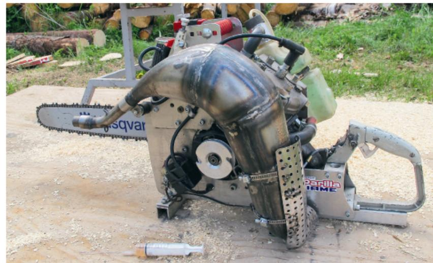
Hot Saw – die geht ab wie eine Rakete. Der Motor ist von Parilla IAME, hat 100 Kubikzentimeter Hubraum und leistet 25 PS bei 1800 U/Min. Ihr Gesamtgewicht beträgt annähernd 20 Kilogramm
