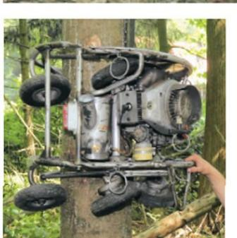
Und auf geht's nach oben zur Wertastung: Die Arme der Klettersäge KS 31 von Sachs umschließen den Baum in der Mitte. Mit Hilfe der Räder kraxelt „Klettermaxe“ spiralförmig den Stamm hoch
